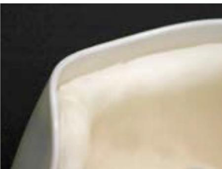
Aceptable: suficiente espesor uniforme sin huecos
